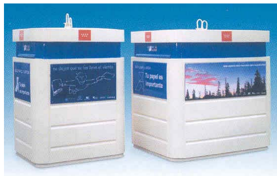
Último modelo de contenedores para papel/cartón instalados en el municipio de Collado Villalba. Características: Color: crema con banda azul, Chapa metálica, pintura antigrafiti, capacidad: 3 m 3 , dimensiones: 160x120 cm de base y 160 cm altura, con apertura a 137,5 cm
