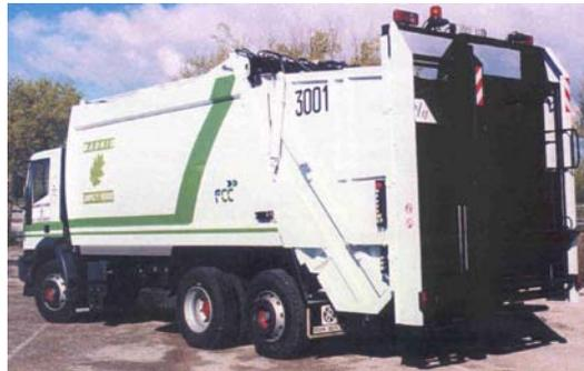
*Vehículo compactador de carga trasera bicompartimentada (municipio de Collado Villalba)*
